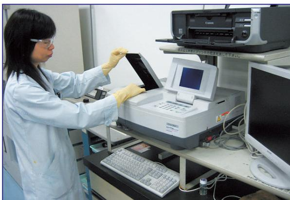
■ 分光光度計による薬品の染料への影響確認
